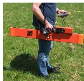
شکل ۱. الف- دستگاه EM-38. هندسه پیچه‌های فرستنده و گیرنده: ب. جهت‌گیری یا مد قائم و پ. جهت‌گیری یا مد افقی بردارهای گشتاور دوقطبی پیچه‌ها
