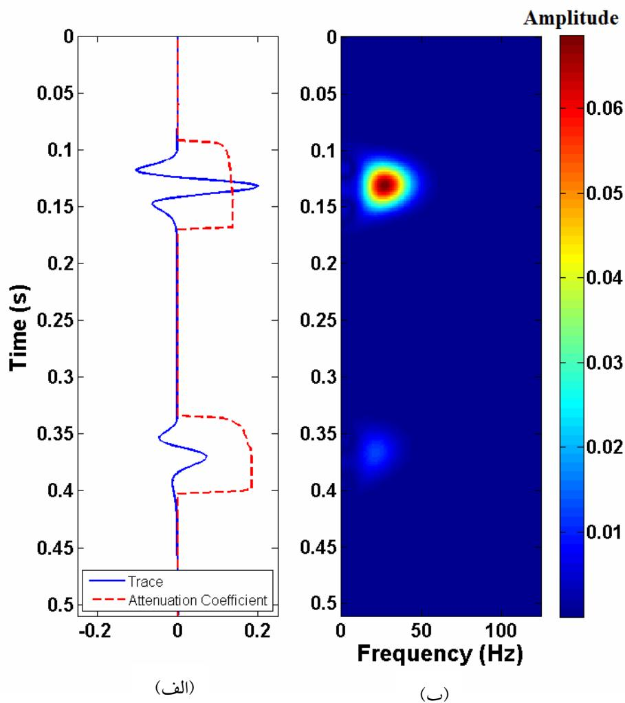
شکل ۵. (الف) ردیلزه مصنوعی (خط آبی) و ضریب جذب برآورده شده (خط چین سرخ)، (ب) توزیع ویگنر-وایبل نمای هموارشده برای ردیلزه مصنوعی.
