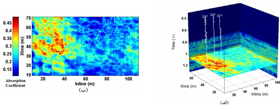
شکل ۱۰. (الف) نمایش سه‌بعدی برش افقی در افق  $1060$  میلی‌ثانیه به همراه نگار مقاومت صوتی موج P در سه چاه متفاوت و (ب) نمایش دو‌بعدی آن (نواحی با رنگ سرخ جذب بیشتری دارند).
