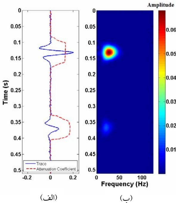
شکل ۷. (الف) ردلرزه مصنوعی دارای نویه (خط آبی) و ضریب جذب برآورده شده (خط چین سرخ)، (ب) توزیع ویگنر- وایل نمای هموار شده برای ردلرزه مصنوعی.
