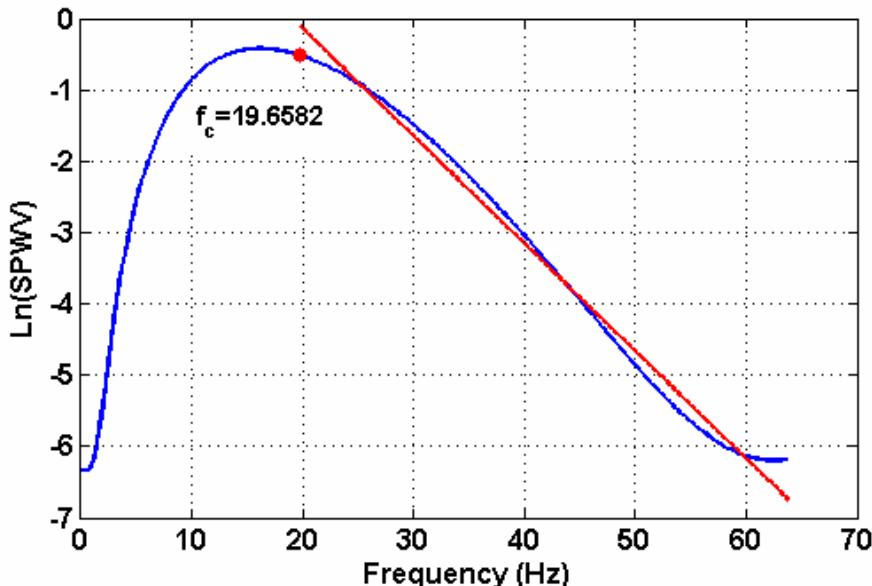
شکل ۴. لگاریتم طیف توزیع ویگتر-وایل نمای هموار شده (خط آبی) و خط برازش داده شده (خط سرخ) به محدوده بسامد مرکزی (نقطه سرخ) تا نصف بسامد نایکوست.
