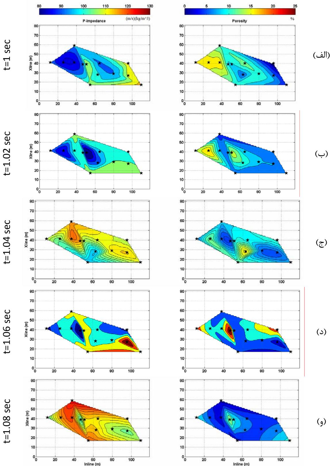
شکل ۱۲. منحنی همتراز مقاومت صوتی موج P (ستون سمت چپ) و تخلخل (ستون سمت راست) برای زمان‌های (الف) ۱/۰۲ ثانیه، (ب) ۱/۰۴ ثانیه، (ج) ۱/۰۶ ثانیه، (د) ۱/۰۸ ثانیه و (و) ۱/۱۰ ثانیه.
