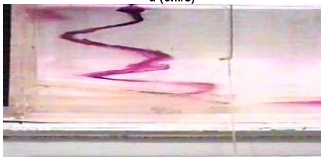
شکل ۹. تصویر بالایی حداکثر لایه‌بندی تشکیل شده در نمایه قائم سرعت شاره در یک راستای قائم حاصل از مدل عددی با شیب ۱۴ درجه، بعد از زمان در حدود ده برابر دوره تناوب شناوری و در تصویر پایینی تشکیل لایه‌های برشی در مدل آزمایشگاهی بیدختی و نوروزی (۲۰۰۵) با شیب ۱۵ درجه بعد از رسیدن به حالت نیمه‌مانا نشان داده شده‌است.
