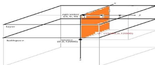
شکل ۲. شمای کلی از نحوه قرارگیری محورهای مختصات، صفحه گسل و ایستگاه‌ها.
