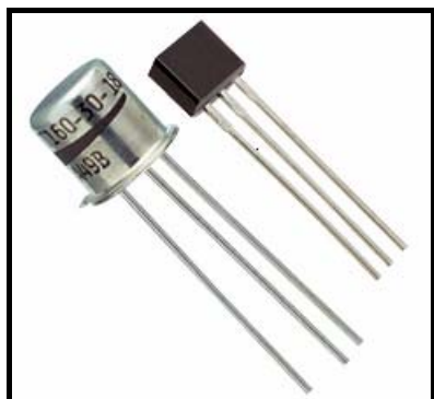
شکل ۲. دریابه دمایی SMT-160-30 استفاده شده در این تحقیق.
