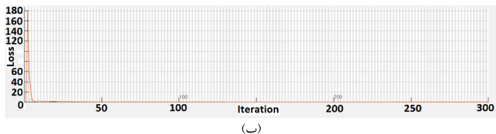
شکل ۲۱. فرایند آموزش شبکه LSTM، محور افقی نشان‌دهنده تعداد تکرارها تا ۳۰۰ و محور قائم نشان‌دهنده تغییرات (الف) جذر خطای مربعی میانگین و (ب) تابع هزینه، می‌باشد.
