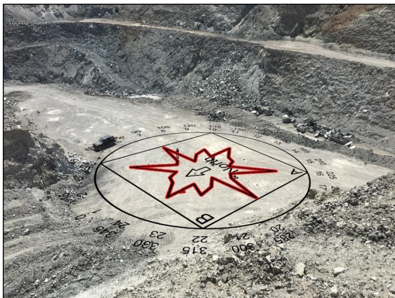
شکل ۷. نمایش نقطه اندازه گیری (مرکز مربع) و نمایش آزمونوتی های اندازه گیری مقاومت ویژه ظاهری در آرایه مربعی در معدن ۱۲. در این شکل، عدد ۱ (سمت چپ عکس) و فلش مشکی جهت شمال (صفر درجه) را نشان می دهد. آزمونوتی های اندازه گیری، به صورت کامل، در شکل ۸ نشان داده شده است. جهت AB اولین اندازه گیری، در هر طول ضلع مربع (با مترآژ مشخص) را نشان می دهد. به خودرو، برای مقیاس، توجه شود. در این شکل، نمودار ستاره ای حاصل از برداشت مقاومت ویژه ظاهری، برای طول ضلع ۱۳/۸ متر، نمایش داده شده است.
