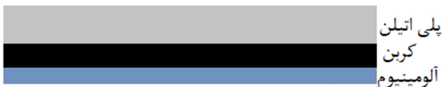
شکل ۳. ساختار چند لایه طراحی شده در این کار.
