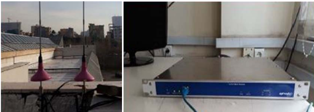
شکل ۲. گیرنده رادیویی و آنتن‌های LF و VLF واقع در مؤسسه ژئوفیزیک تهران.
